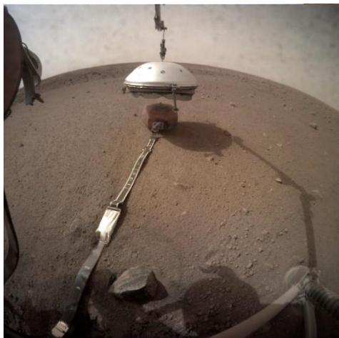
SOL 66: Das WTS wird abgesetzt
