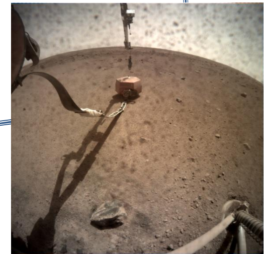
SOL22: SEIS wird abgesetzt
