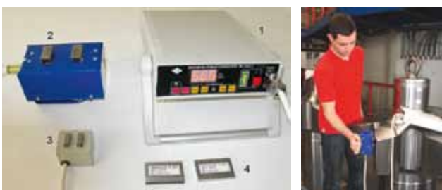
Abb. 3: 1-Strukturprüfgerät MC-04H2, 2-großer, 3-kleiner Aufnehmer, 4-Kalibrierkörper. Rechts: Einsatz des Gerätes in einer Härtereianlage zur Kontrolle der einsatzgehärteten Schicht großer Zahnräder Modul 100
