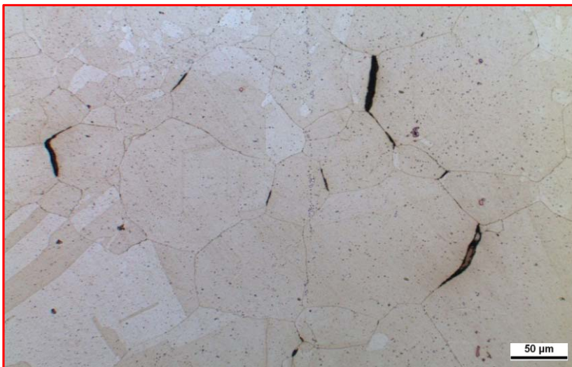
Ductility Dip Cracking in der WEZ von alloy 617 in Folge einer WIG-Schweißung im PVR-Test
