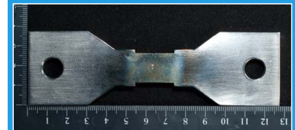
STF-Probe in der Gleeble® und thermo-mechanischer Zyklus im Strain-to-Fracture (STF) Test
