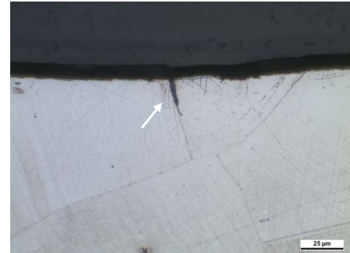
Lichtmikroskopische Aufnahme der DDC im Querschliff (750°C, 14% Dehnung)
