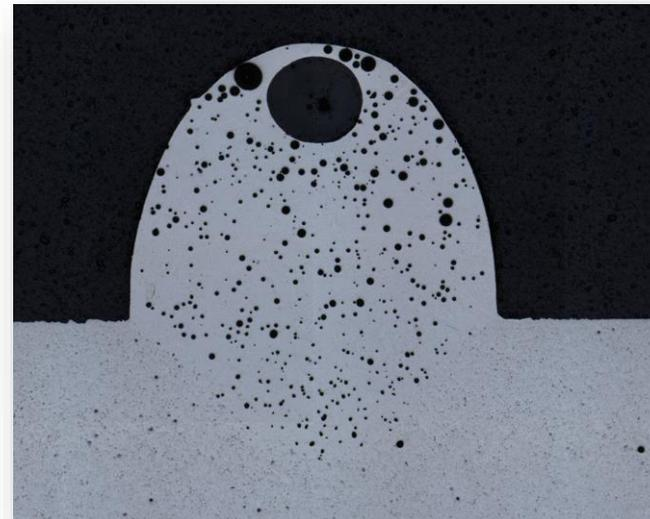
MIG-Schweißnaht auf Aluminium-Druckguss
