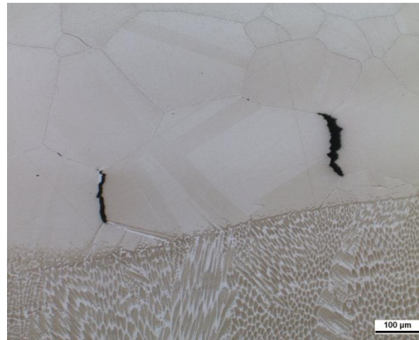
Wiederaufschmelzrisss Typ 1B
